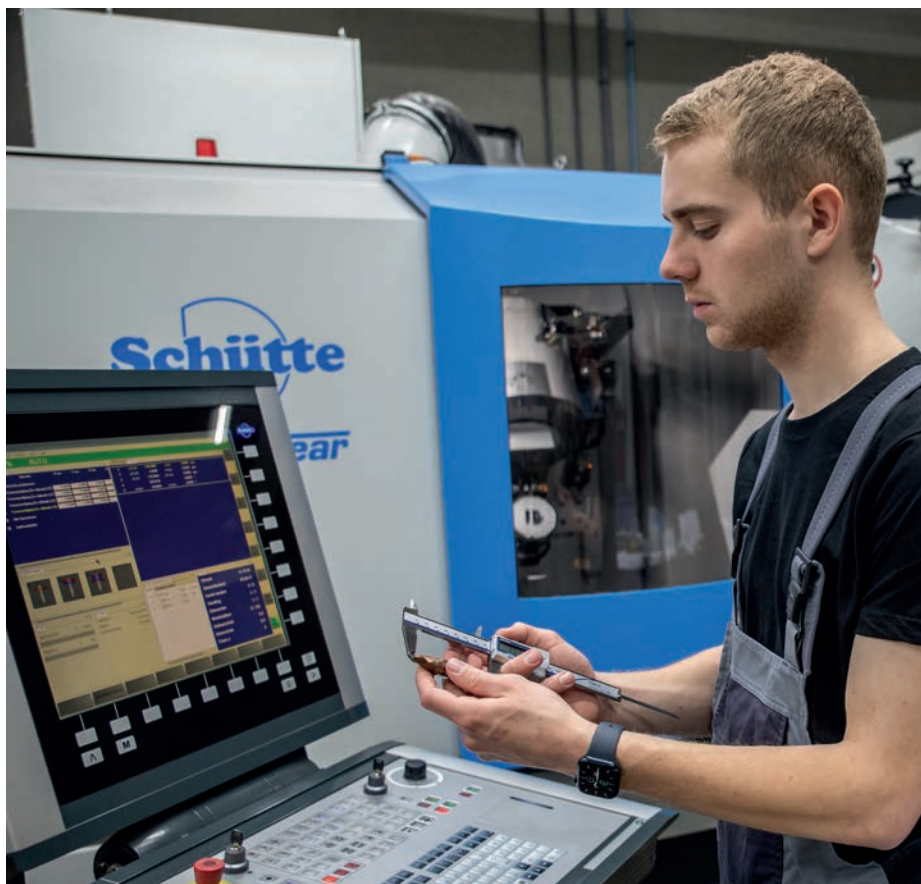
Een medewerker controleert de maatvoering.
