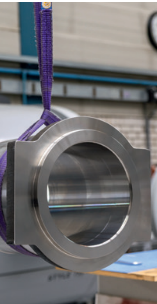
André Amersfoort bij een rvs machineframe voor een separator voor o.a. fruit en vis.
