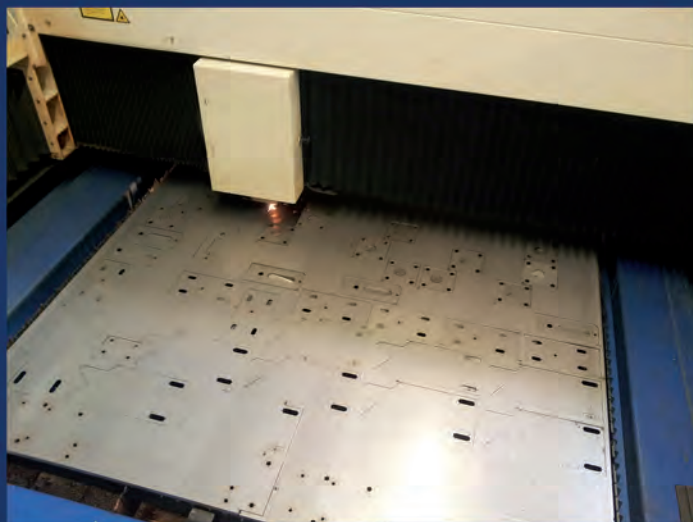
Gevlakt MET skinpass: LaserpressPlus® kwaliteit
